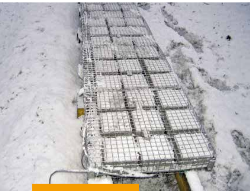
150 millimetrin kuutioita Kotkan koekentällä. Niistä seurataan suola-pakkasrauhaa tilavuudenmuutoksena.
