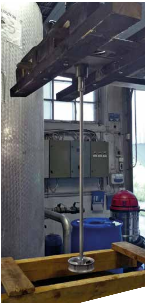
Kuvat vasemmalla ja keskellä: Betonin lisäaineet on suositeltavaa sekoittaa mekaanisesti esimerkiksi lapasekoittimella.
