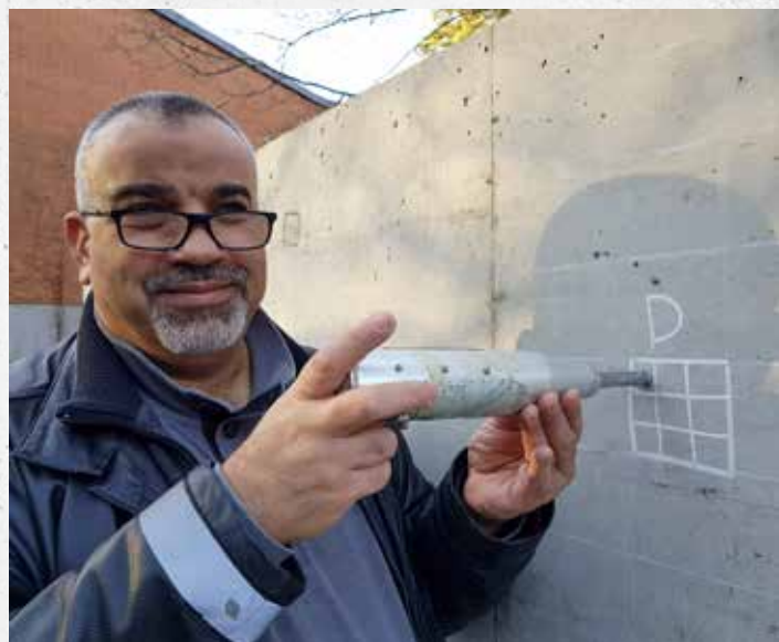
Fahim Al-Neshawy käsissään kimmovasara, jota käytetään betonipinnan lujuuden mittaamisessa.
