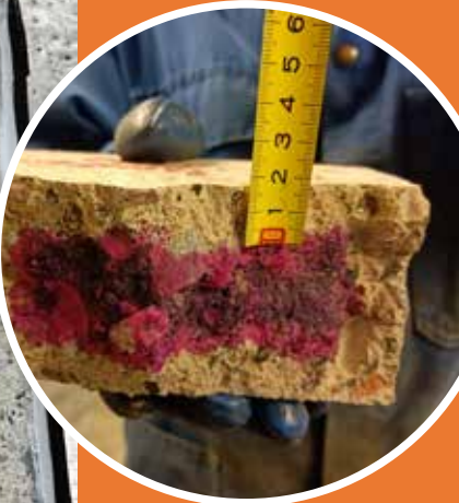
Kuonabetonin karbonatsoituminen kiihdytetyssä kokeessa.
