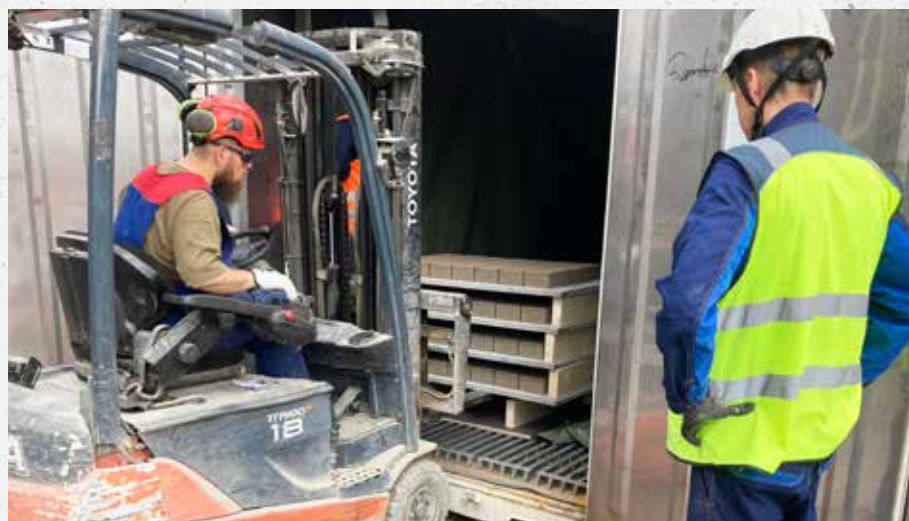
Betonitehtaan yhteydessä Hollolassa on kontti, jossa hiilidioksidia sitoutetaan automatisoidulla järjestelmällä betonikappaleisiin. Prosessi tapahtuu ilmanpaineessa ja on helposti toteutettavissa nykyisissä tuotantoprosesseissa.
